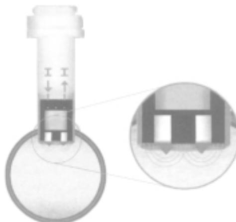
Magnetoindukcyjny przetwornik przepływu jest przeznaczony do pomiaru natężenia przepływu cieczy zanieczyszczonych i / lub lepkich o przewodności nie mniejszej, niż 20  $\mu\text{S} / \text{cm}$ . Wbudowany przetwornik 4...20 mA umożliwia zastosowanie przyrządu w układach regulacji. Wyświetlacz i menu pozwalają na wprowadzenie własnych nastaw wszystkich mierzonych parametrów (patrz dane dla poszczególnych modeli).
